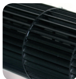
Sisäyksikön puhaltimien siivekkeet 10 vuoden jälkeen ilman pinnoitusta.
